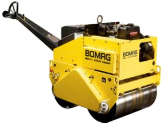
Equipo con capacidad de compactación de 700 kilos hasta 1 tonelada, de fácil manejo, funciona con motor a gasolina de 4 tiempos.
